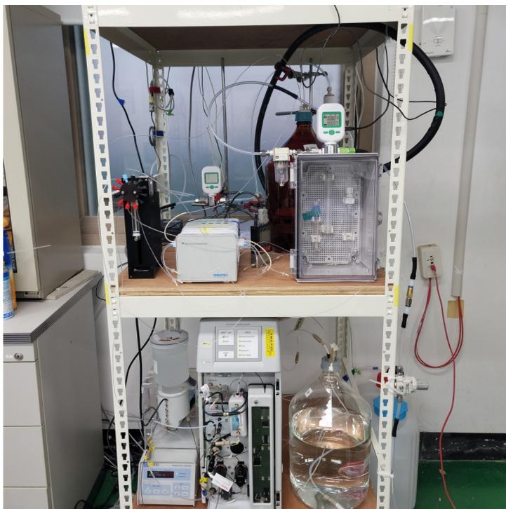
그림 4. 준실시간 미세입자 포집기 (PCS(좌)) 및 준실시간 HNO<sub>3</sub> 측정 분석 시스템(우)
